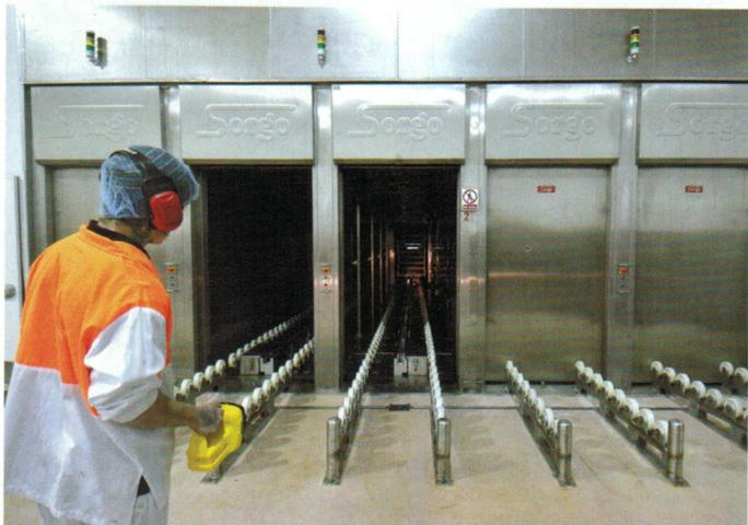
Konti-Anlagen für Stundenleistungen von bis zu 10 Tonnen Wurstwaren.
